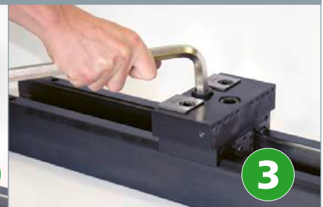
Zwei Schrauben anziehen Fasten two screws
