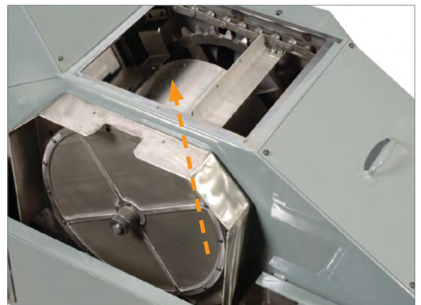
Magnettrommel zur Abscheidung von feinen Gusseisenspänen
