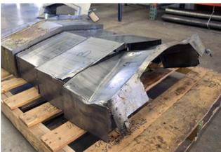
4. Ist Ihnen ein Werkzeug oder Werkstück auf die Abdeckung gefallen, kann ein neues Kastenelement notwendig werden.
