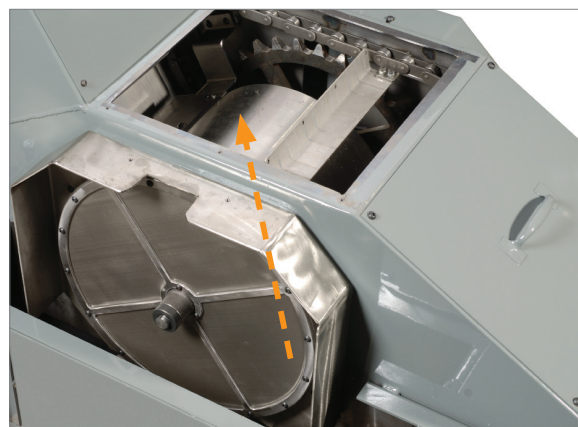
Tamburo magnetico per la separazione di trucioli fini di ghisa
